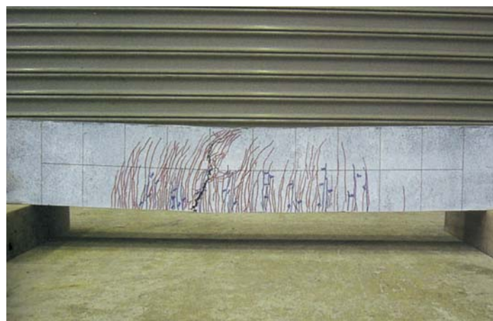
サクセムの優れたひび割れ分散性による高いじん性
